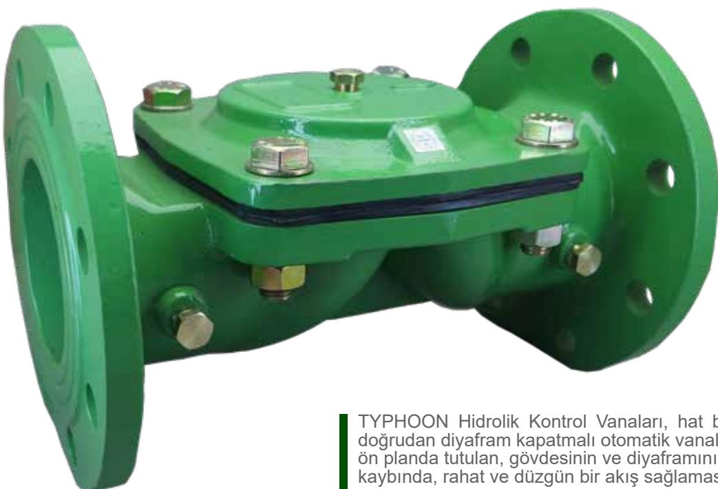
TYPHOON Hidrolik Kontrol Vanaları, hat basıncı ile çalışan doğrudan diyafram kapatmalı otomatik vanalardır. Tasarımında ön planda tutulan, gövdesinin ve diyaframının minimum basınç kaybında, rahat ve düzgün bir akış sağlamasıdır.
